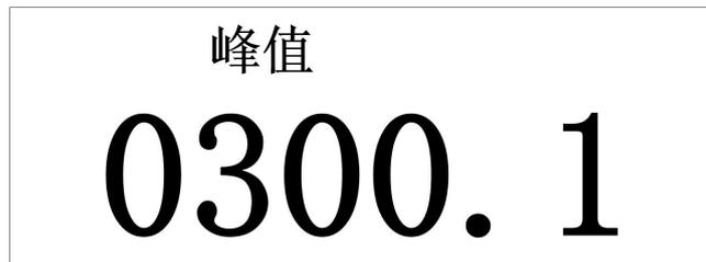
测量完成后按
