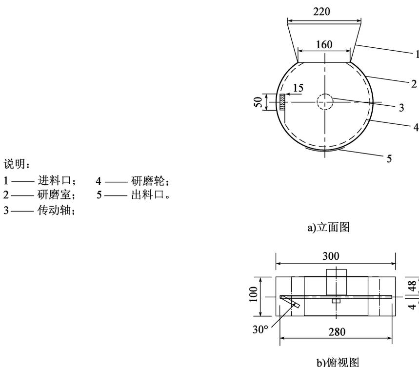
图 L.2 研磨系统结构示意图(尺寸单位:mm)
