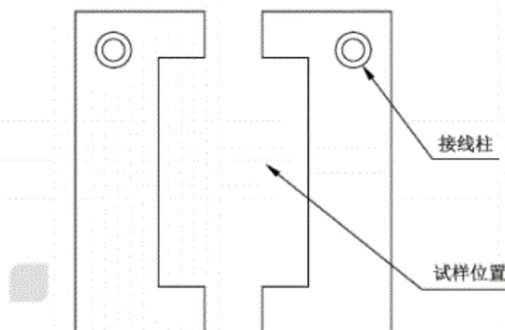
图 A.2 试样夹持工装
