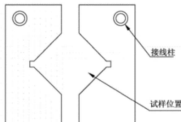
图 A.1 试样夹持工装
